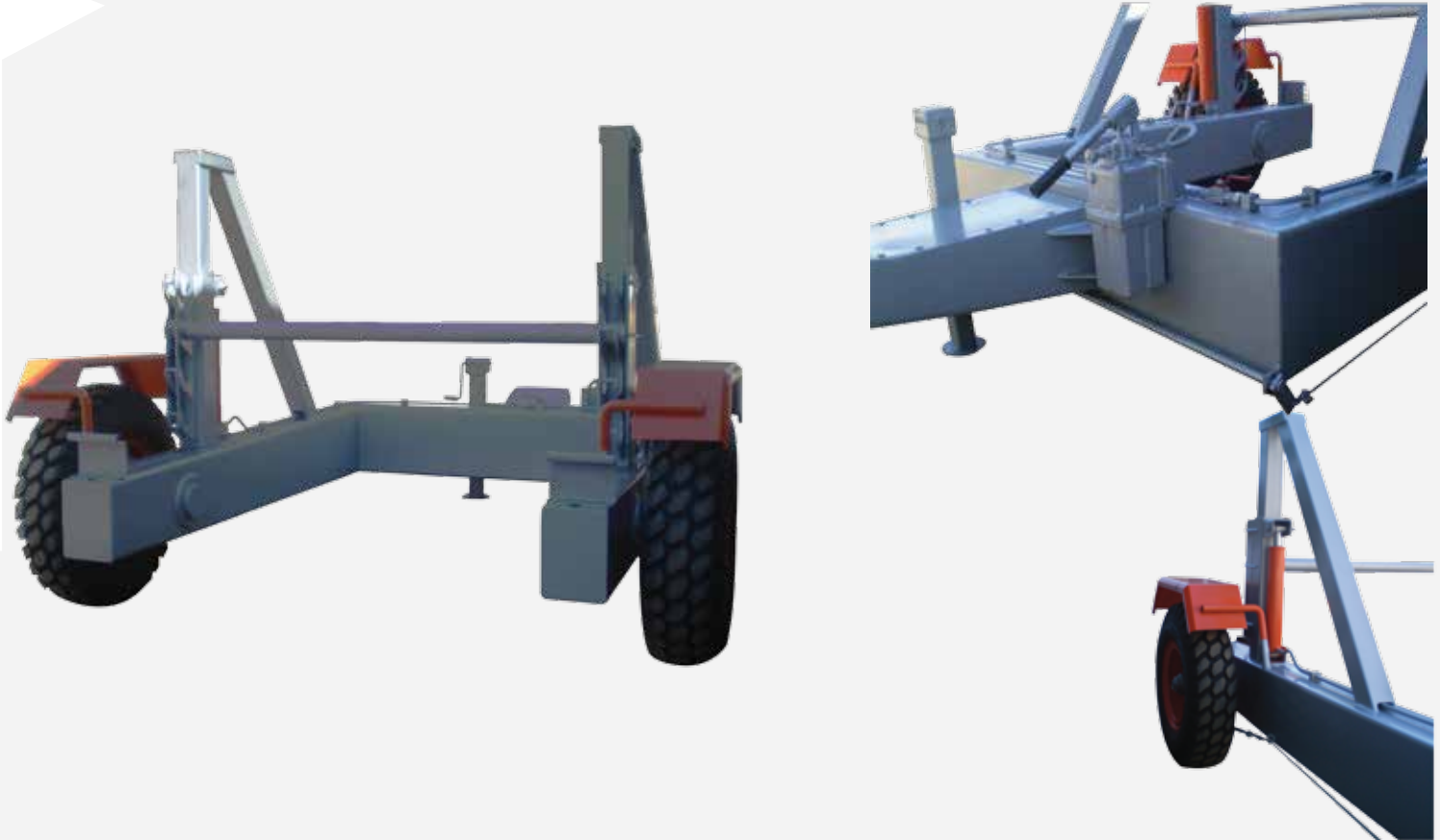
Kablo Makarası Taşıma Römorku / Cable Roller Transport Trailer (3.5 - 5 Ton)
